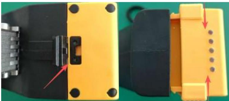
充电插头转换器与电池连接时方向按下图示意。
